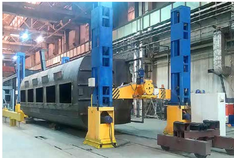
Система электрооборудования выполняет следующие функции: включение и выключение электрооборудования кантователя; управление операцией загрузки и вращения кантователя, как в ручном так и в автоматическом режиме; дистанционное управление исполнительными устройствами кантователя по радиоканалу с пульта; непрерывный контроль положения исполнительных механизмов. Световая индикация на панели управления оповещает об аварийном завершении работы кантователя при возникновении внештатной ситуации.
