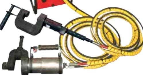
Установки для снятия (выпрессовщики) и постановки заклепок фрикционных планок
