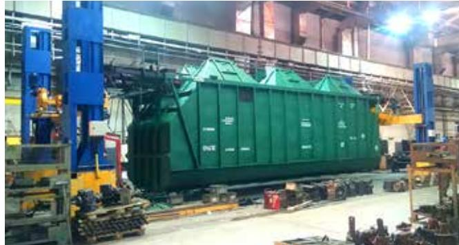
Подъёмная каретка передвигается вверх или вниз между двумя конечными позициями. Колонны снабжены концевыми датчиками, которые при достижении крайних положений производят автоматическое отключение приводов.
